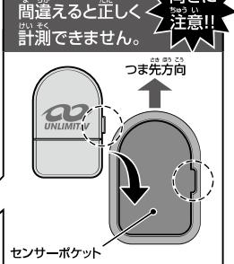
②コイン電池を入れたセンサユニットを向きを間違えないようにセンサポケットにセットします。
